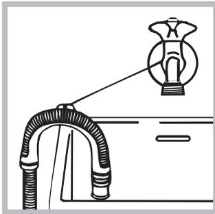
! Не рекомендуется применение удлинителей для сливного шланга, при необходимости допускается его наращивание шлангом того же диаметра и длиной не более 150 см.
