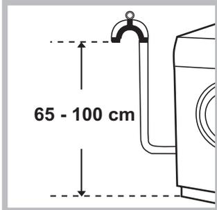
Повесьте загнутый конец сливного шланга на край раковины, ванны, или поместите в специальный вывод канализации. Шланг не должен перегибаться. Верхняя точка сливного шланга должна находиться на высоте 65-100 см от пола. Расположение сливного шланга должно обеспечивать разрыв струи при сливе (конец шланга не должен быть опущен в воду). В случае крепления на край ванной или раковины, шланг вешается с помощью направляющей (входит в комплект поставки), которая крепится к краю (рис.).
